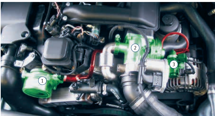
Ejemplo BMW 118d (E87): Componentes en el sistema de depresión (verde), mangueras de depresión (rojo)
