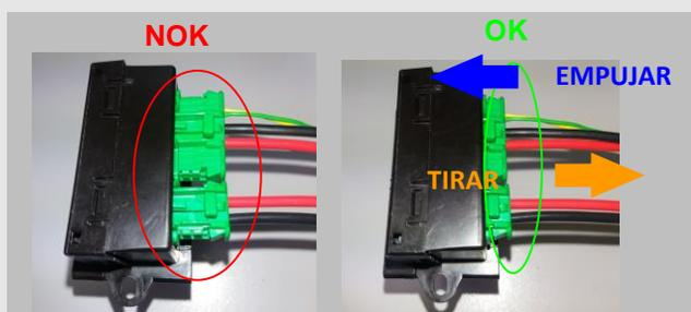
Comprobar que la conexión es correcta en ambos conectores, empujando y tirando, como se indica en la imagen.
