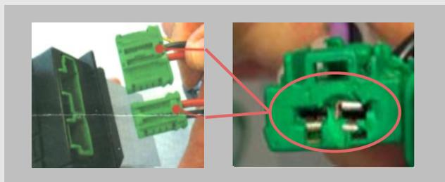
Verificar las condiciones del cableado y de los terminales. Si los terminales están bien, ir al paso 2. Si los terminales están dañados utilizar la referencia 710355
