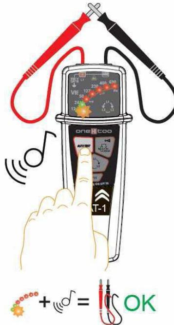
Este test permite controlar totalmente el funcionamiento correcto del VAT: desde las puntas de prueba hasta los diodos electroluminiscentes (salvo LED de rotación de fases), la electrónica, el zumbador y las pilas.
