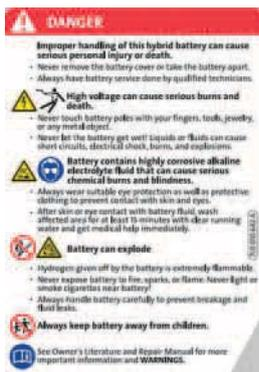
**Identificación especial de la batería de alto voltaje**
