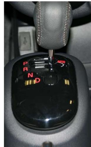
La marcha atrás se obtiene mediante la inversión del sentido de rotación del motor. Por su construcción, el vehículo podría circular con la misma velocidad tanto en marcha atrás como en marcha adelante, pero para evitar los riesgos de pérdida de control la velocidad marcha atrás está limitada a 40 km/h.
