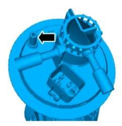
Si el vehículo tiene calefactor de aparcamiento, taladre el agujero de conexión en el armazón del depósito. Use una broca de Ø4 mm. Coloque el tubo de inmersión.
