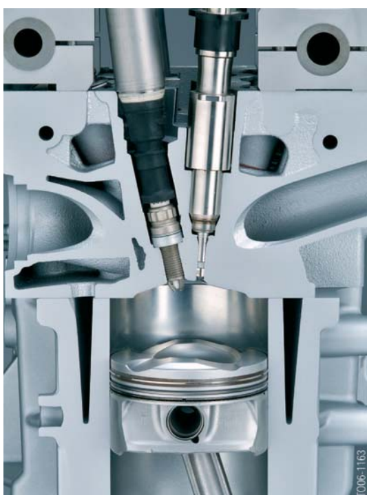
32 - Posición de montaje del inyector piezoeléctrico con apertura al exterior
