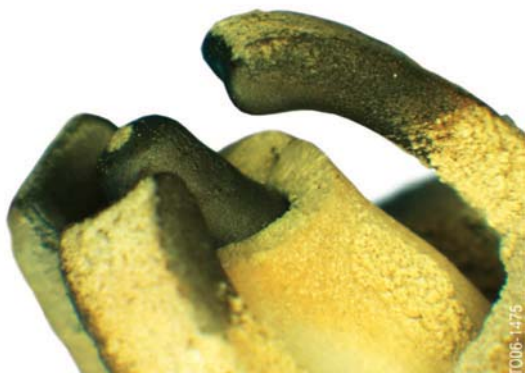
36 - Imagen de daños por desplazamiento brusco del aislante
