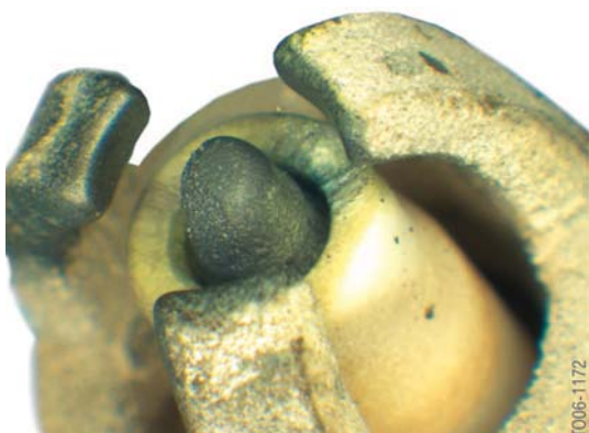
37 - Imagen de daños por calcinación del electrodo en un lado
