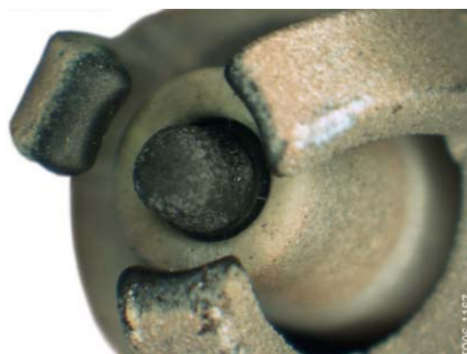
39 - Bujía en buen estado tras estar en servicio durante 100.000 km
